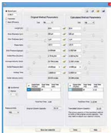
使用方法计算器易于地建立能够缩短分析时间的方法或适应载气变化的方法
