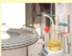
774全自动卡氏样品加热进样器实验条件重复性极佳、高效、省时、省力，可配合Metrohm容量法或库仑法卡氏水份测定仪使用，实现全自动样品转换和困难样品分析两者完美的结合。
